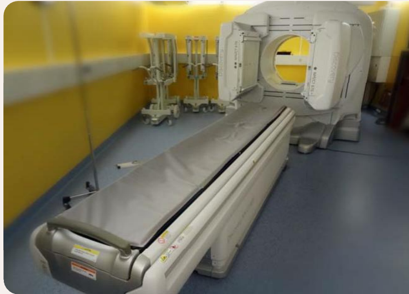
Figure 1 | Camera Ge discovery SPECT-CT (ou TEMP-TDM) dite « hybride » car elle associe 2 têtes de détection des rayonnements gamma à un scanner CT. L'appareil est installé dans le service depuis octobre 2012.
