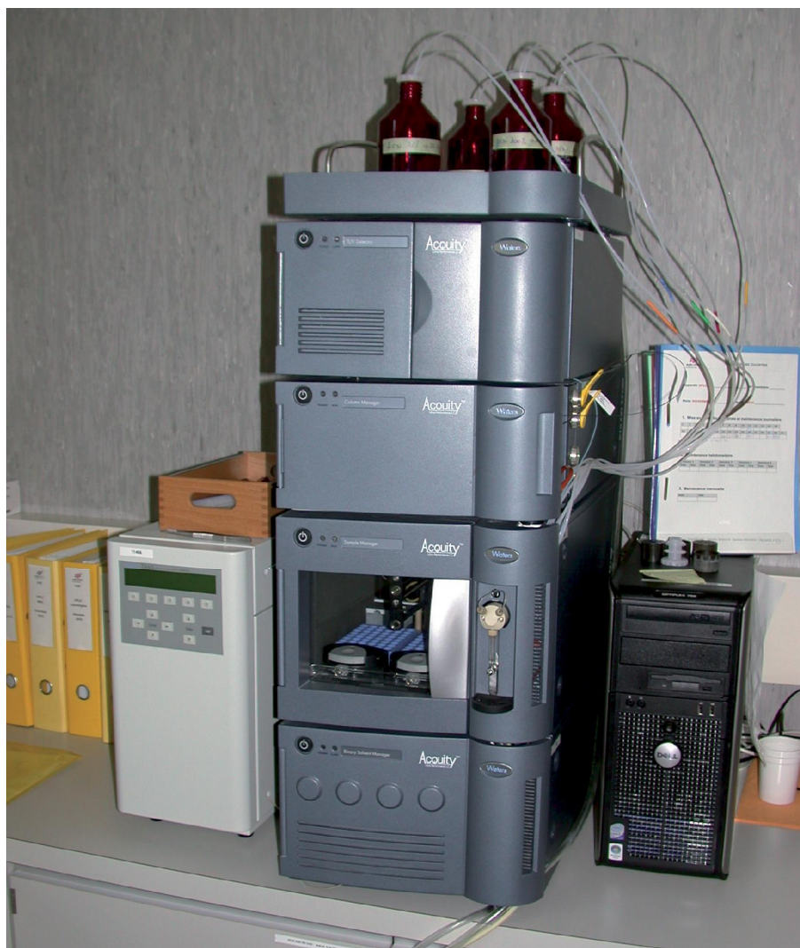
Système LC-UV /LC-EC WATERS Acquity (UPLC avec détecteur UV).
